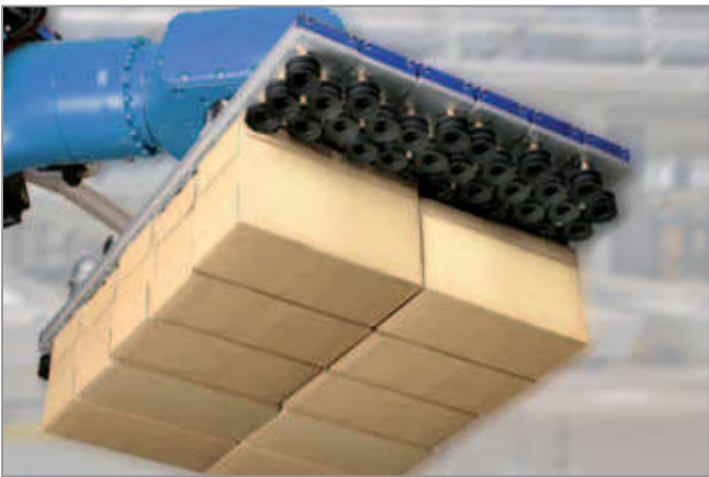
整层搬运的真空夹具系统 PZ
