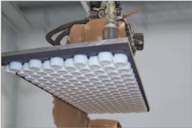
整层搬运的真空夹具系统 PZ
