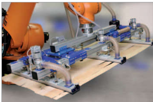
带有大面积真空夹具的真空端拾器 SP-MC
