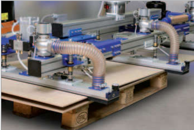
真空端拾器 SP-MC 采用可伸缩式设计搬运刨花板
