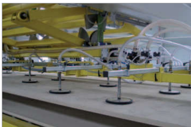
带有真空吸盘的真空端拾器 SP
